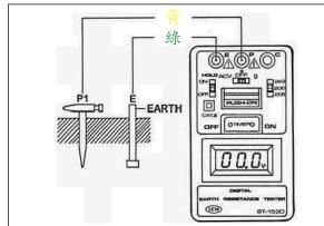
接地電阻量測接線圖
